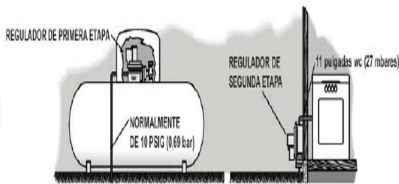
Figura 44.- Posición de reguladores de primera y segunda etapa.
