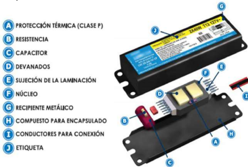
Figura 29.- Partes de un balastro
